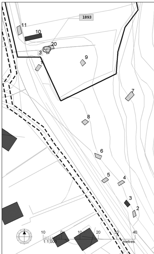
Ill. 7. Schakt och anläggningar i den södra delen av undersökningsområdet, teckenförklaring finns på ill 9 på sid 11. Anläggningsnummer är angivna med kursiva siffror till skillnad från schaktnummer.
