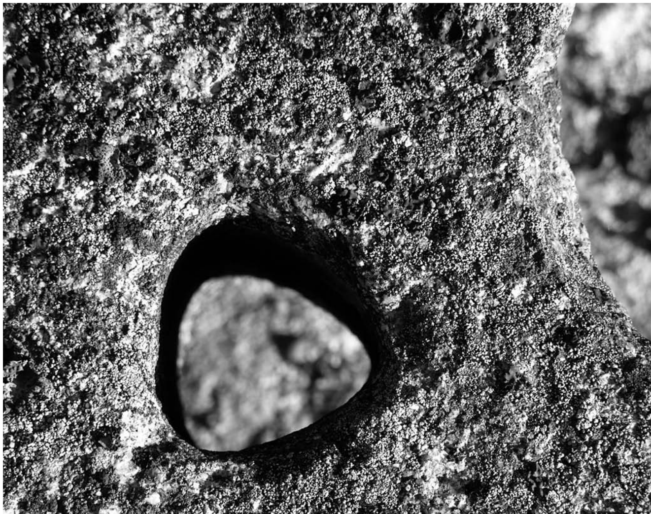
Bild 3. Triangulärt borrhål i löst block.
