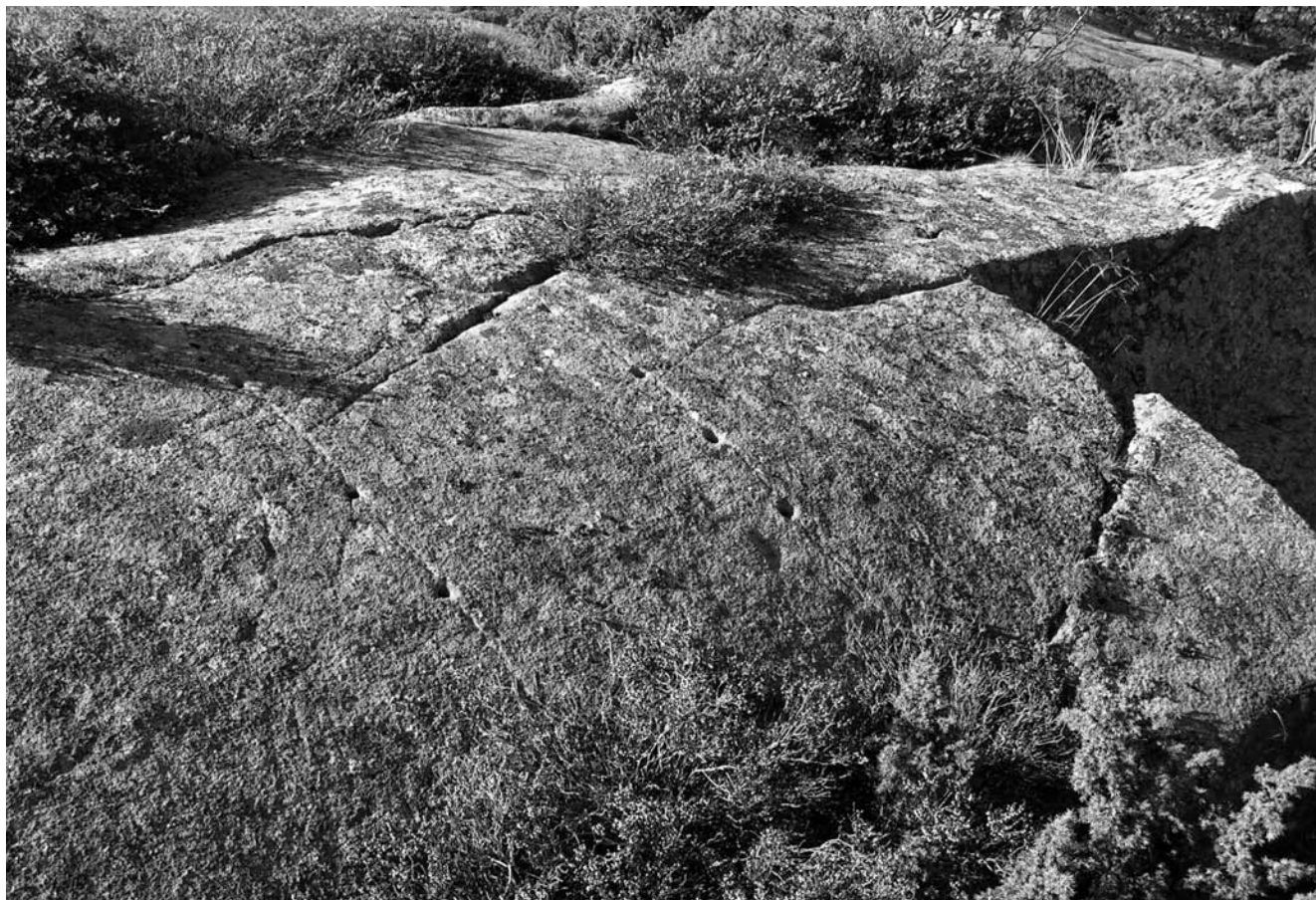
Bild 5. Ritsar och borrarade hål för rundkilar.
