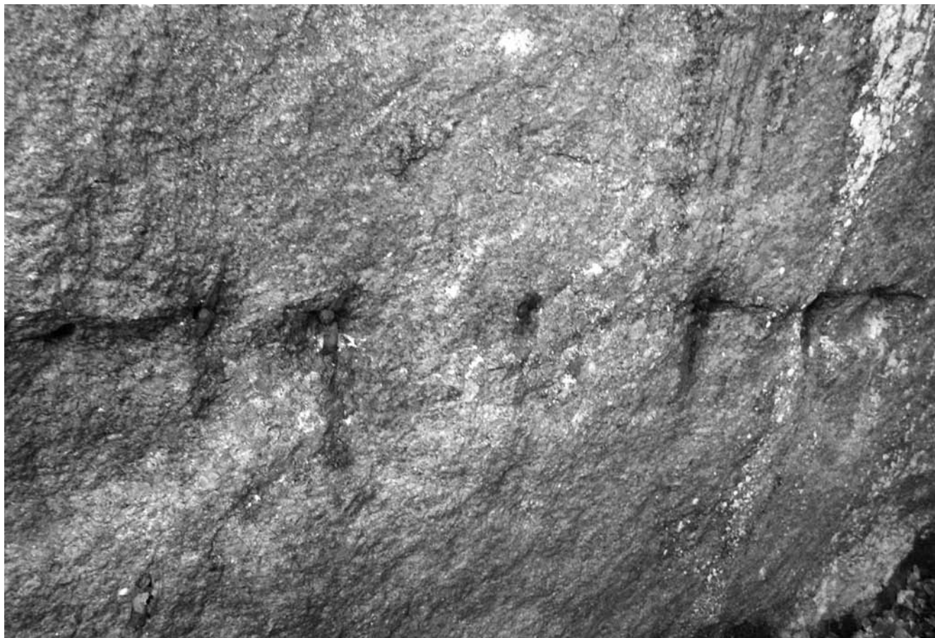
Bild 7. Rundkilar för horisontell klyvning. Jämför även med bild 1.
