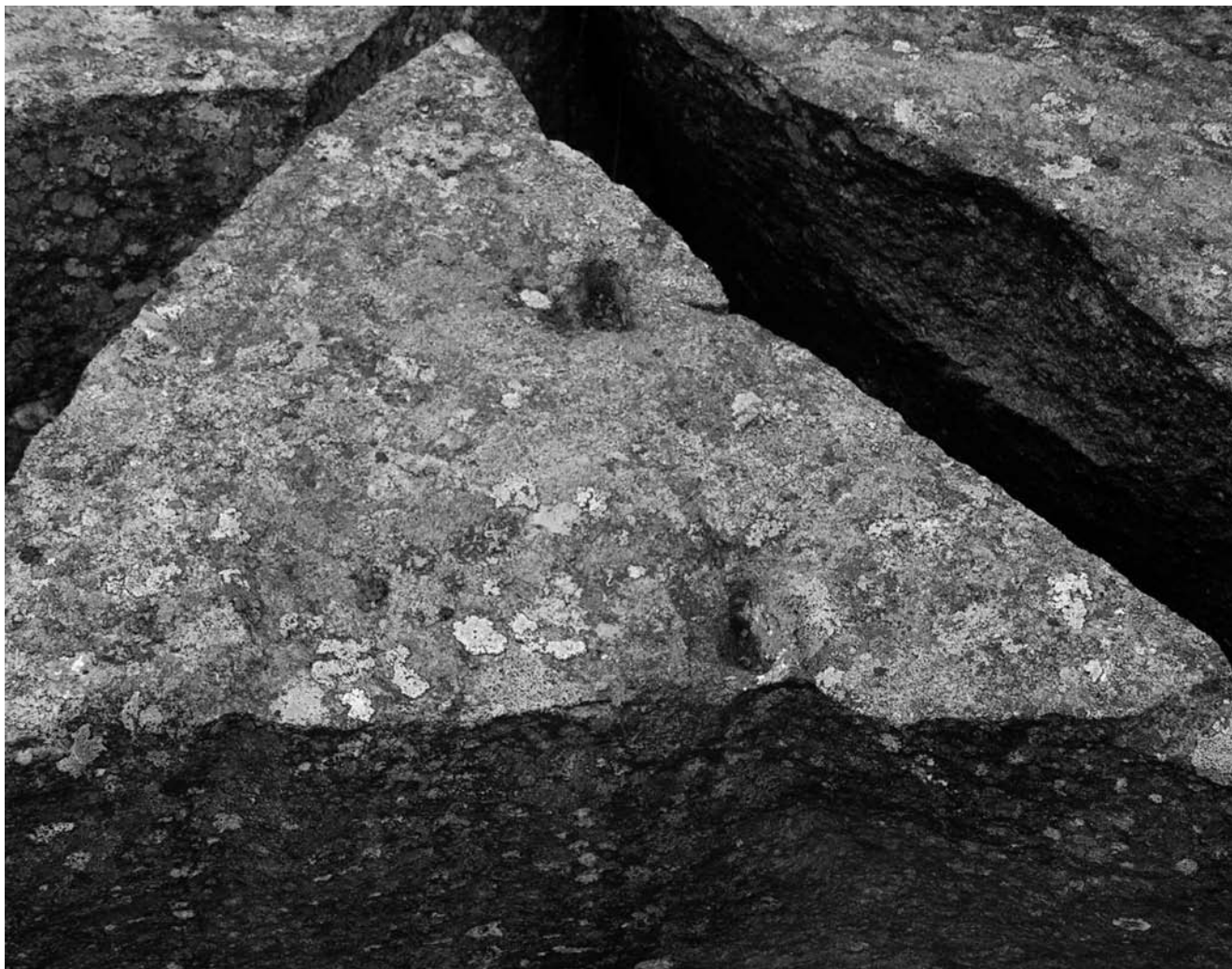
Bild 4. Huggna hål för bredkilar.
