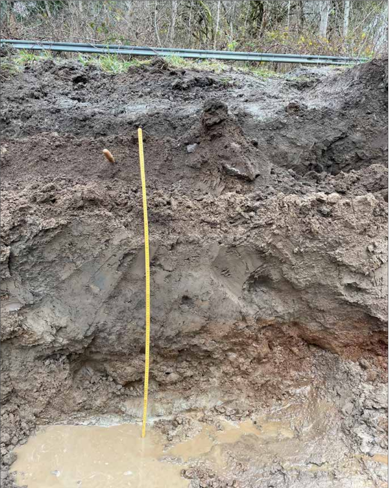
Figur 18. Foto av profilen i djupschakt S112 där grus- och sandlager syns. Foto mot norr.
