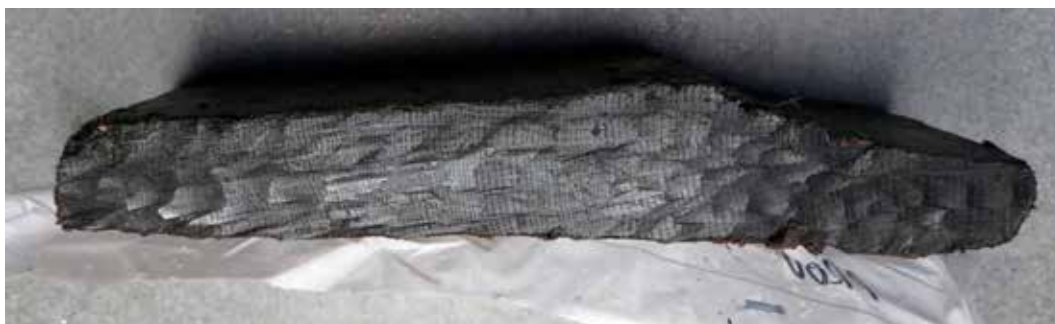
Fig. 4. Skibsvrag Klippan 2, Sverige. Tværsnittet af plank 155. Planken er tangentielt skåret fra træet. Vækstretningen er højere til venstre.
