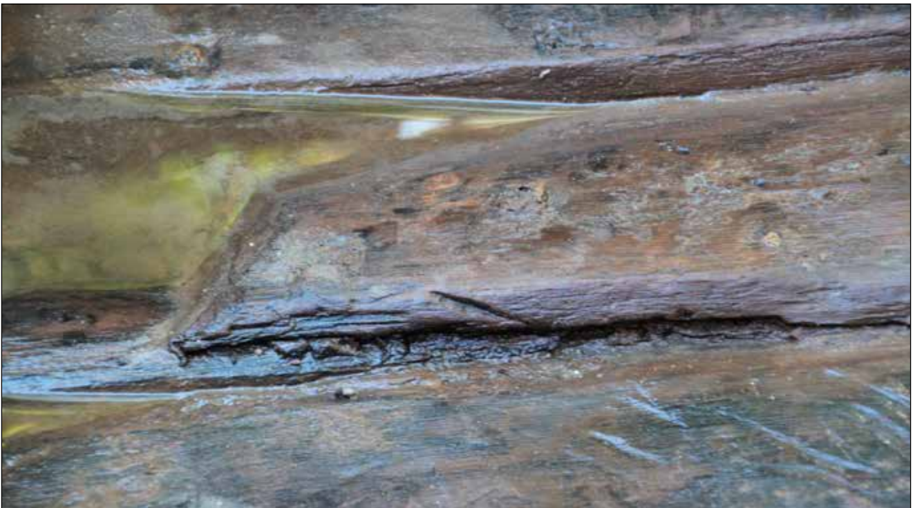
Figur 69. Detalj av bordlask i bordgång 4 på babordssidan som visar hur bordets kortända fasats av för att möta det underliggande bordet.
